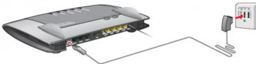
Abb.: FRITZ!Box per DSL-Kabel mit IP-basierten DSL-Anschluss verbinden
